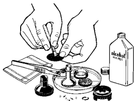
Pulizia manuale con alcol (min. 90%)
