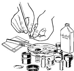
Pulizia manuale con alcol (min. 90%)
